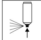
Nach Beenden des Lackiervorganges Dose umdrehen und Ventil leersprühen, um ein Verkleben des Sprühventils zu vermeiden.
