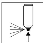
Nach Beenden des Lackiervorganges Dose umdrehen und Ventil leerspritzen, um ein Verkleben des Sprühventils zu vermeiden.
