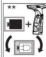
Wechselakku und Gerät gleich-zeitig in die Ladestation setzen
