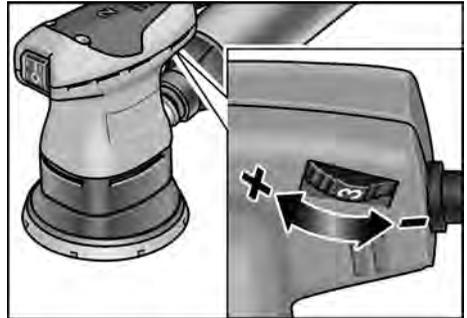
Mit dem Stellrad kann die Schwingzahl auch während des Betriebes von 1 (niedrig) bis 6 (hoch) stufenlos variiert werden.
