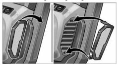
Staubfilter abnehmen und mit trockener Druckluft ausblasen.
