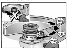
Schutzhaube entgegengesetzt zum Drehrichtungspfeil auf dem Getriebekopf bis zur erforderlichen Position drehen.
