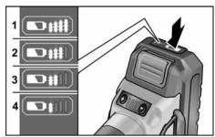
Die Anzeige erlischt nach 5 Sekunden. Blinkt eine der LED, muss der Akku geladen werden. Wenn nach dem Drücken der Taste keine LED leuchtet, ist der Akku defekt und muss ersetzt werden.
