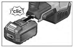
Zum Entnehmen die Entriegelungstasten drücken (1.) und Akku herausziehen (2.).
