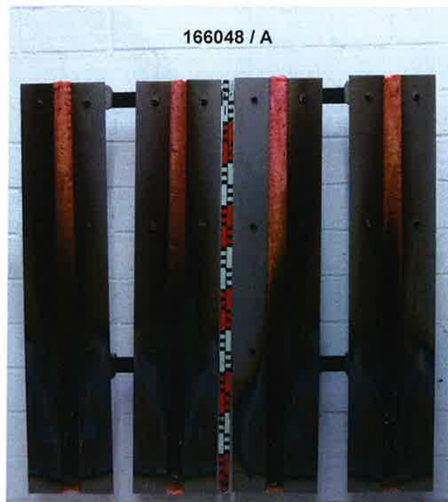
Bild 3: Aussehen des Probekörpers A nach 10-minütiger Beflammung
