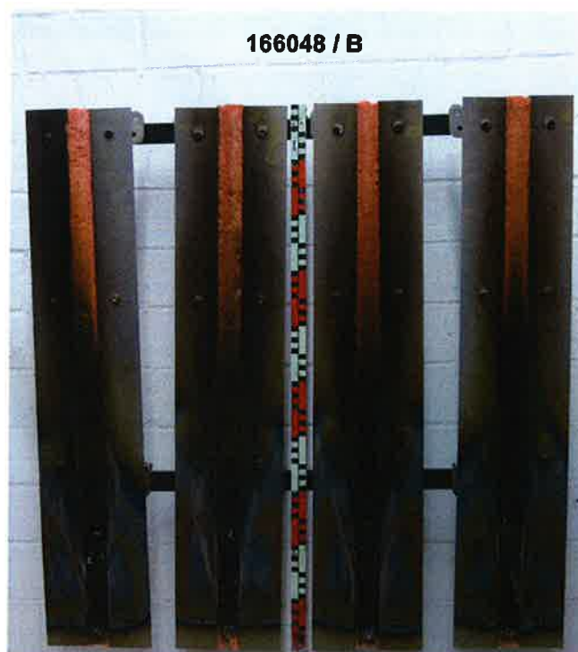
Bild 4: Aussehen des Probekörpers B nach 10-minütiger Beflammung
