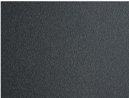
1. 1 satter Spritzgang aus 90 cm Entfernung, Spraydose dabei langsam führen und Lackmaterial gleichmäßig in überlappenden Spritzgängen applizieren, bis ein geschlossener Lackfilm vorliegt
