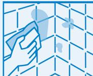
Um noch vorhandene Staubpartikel zu entfernen, die getrocknete Fläche mit dem Staubbindetuch nachwischen.
