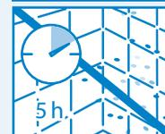
Nach ungefähr 5 Stunden ist die Beschichtung staubempfindlich. So lange Luftzug und Staubentwicklung vermeiden. Nach ca. 8-24 Stunden können die Klebebänder entfernt und die Silikon-Neuverfugung vorgenommen werden.
