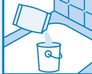
Kalkablagerungen auf Fliesen und Fugen mit der im Set enthaltenen Entkalker (Zitronensäure-Granulat) beseitigen. Hierzu den Inhalt des Entkalker-Beutels in 2 Litern Wasser auflösen. Achtung: Kontakt zu Haut und Augen vermeiden. Bei Augenkontakt sofort mit Wasser spülen.
