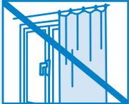
Alle Staubquellen wie z.B. Handtücher, Vorhänge etc. entfernen und bei der Verarbeitung fusselfreie Kleidung tragen. Staubentwicklung durch Luftzug vermeiden.
