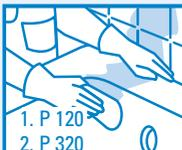
Die gesamte Wanne erst mit grobem Schleifpapier (P120), dann mit feinem Schleifpapier (P320) nass schleifen. Raue Stellen müssen vollständig glatt geschliffen werden. Mit klarem Wasser nachwaschen
