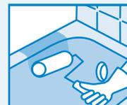
Farbrolle nur so weit auf den Rollenbügel aufstecken, dass die Rolle nicht streifen kann. Zur Erzielung einer einheitlichen Schichtstärke mit der Rolle den Lack abwechselnd in Längs- und Querrichtung gleichmäßig verteilen. Vorgesehene Arbeitszeit: ca. 20 Minuten
