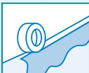
Nicht zu beschichtende Flächen abkleben. Die Wanneneinlauf-Armatur in einen Plastikbeutel einbinden, damit keine Wassertropfen in die Wanne fallen können. Die Auslauf-Armatur kann mit überlackiert werden. Alte Silikonfugen werden entweder ebenfalls abgeklebt oder entfernt und später neu verfugt.
